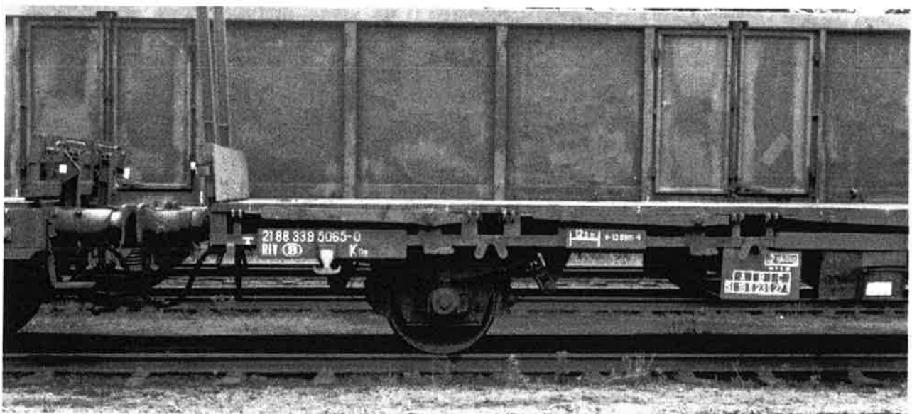
A l'avant-plan : détail du wagon plat Kps, sans haussottes latérales, n°21 88 339 5 065-0. Ici, les ranchers sont rabattus. (photo Claude Carpet)
