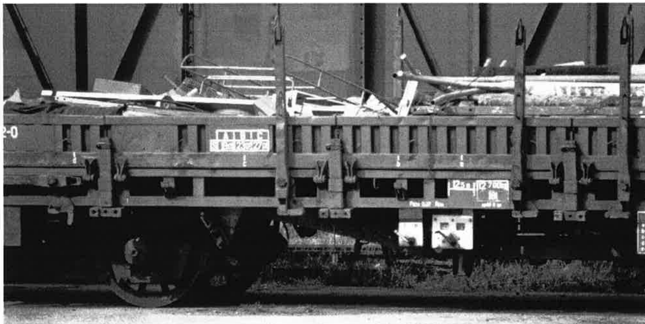
Charleroi-Sud Quai, vue rapprochée d'un autre Ks chargé, entre-autre, de poteaux d'éclairage. Ce wagon est muni d'un essieu plein (à droite) et d'un essieu à rayons (à gauche). Roco a très bien représenté cette différence dans sa référence 46545.
