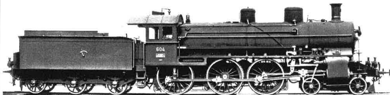
La vraie locomotive pour trains directs A 3/5 suisse qui aurait inspiré Liliput qui n'a pas rectifié l'emplacement de la bielle motrice restée sur l'essieu central. Poids en ordre de marche 114 tonnes, vitesse maximum 100 km/h, puissance à la jante 1600 CV (photo SBB).
